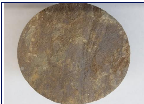
Widok powierzchni przełamu skały
