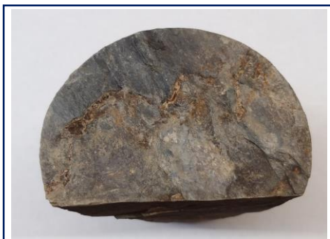
Widok powierzchni przełamu skały
