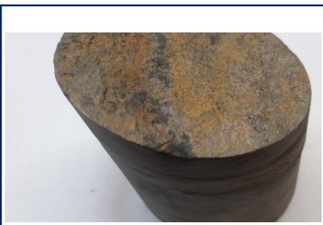
Widok powierzchni przełamu skały
