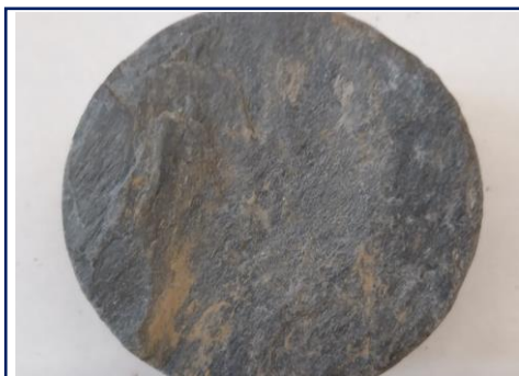
Widok powierzchni przełamu skały
